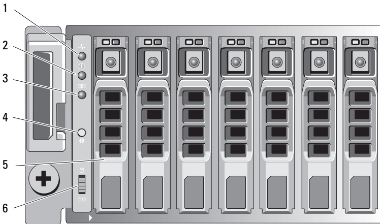
Ilustración 1-2. Indicadores y funciones del panel anterior—Dell PowerVault MD1220
